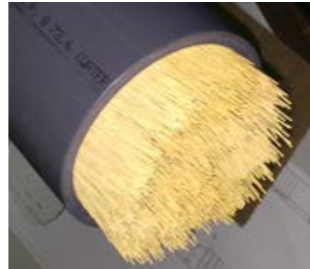
Actual 4-in module assembled at Generon (8/6/16)
